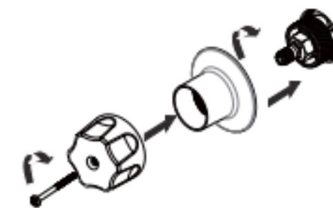
PASO 3: Rosque el chapeton (3) sobre la rosca del cuerpo (6) hasta apretar firmemente, enseguida Inserte el maneral (2) en el estriado del cartucho (4), finalmente Inserte y apriete el tornillo (1) para fijar firmemente el maneral (2). Repita con el otro maneral.
